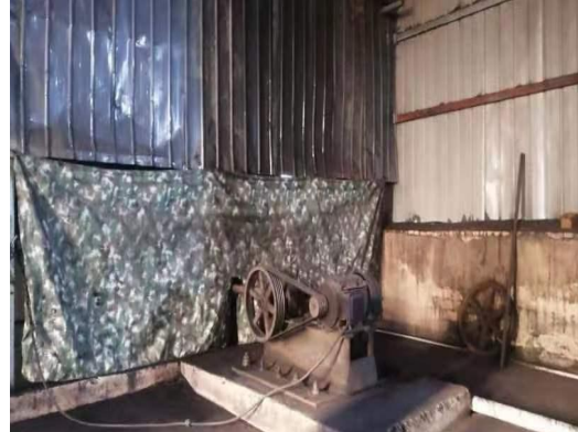
图 6 破碎生产线密闭罩
