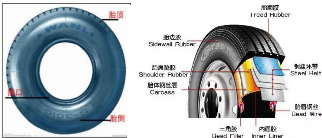
图 3-3 轮胎分解示意图
