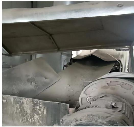
图 17 输送细破上料口设集气罩
