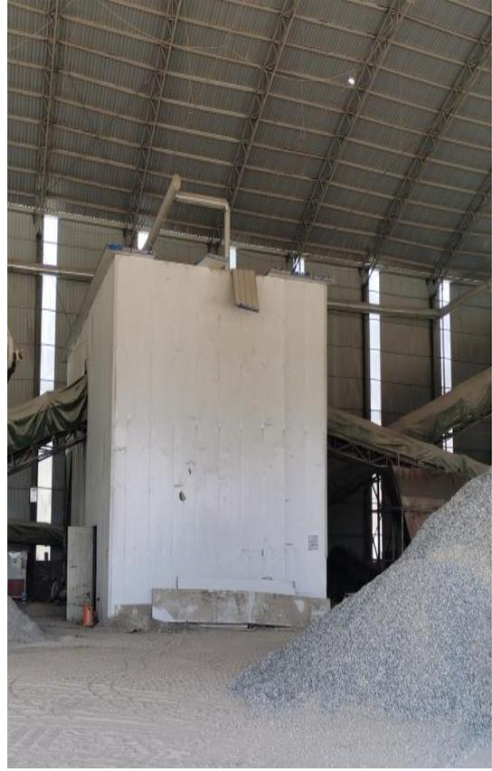
图 15 细破机设密封间
