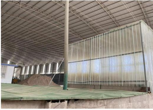
图 18 给料口设半封闭罩+粗破下沉+密闭
