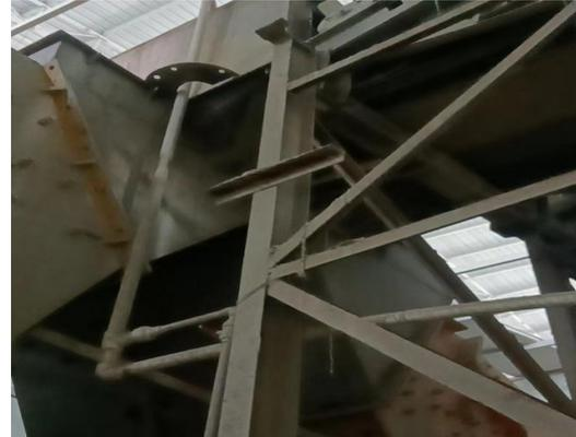
图 10 细破机上方设水喷淋头
