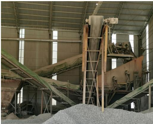
图 11 运输带封闭罩
