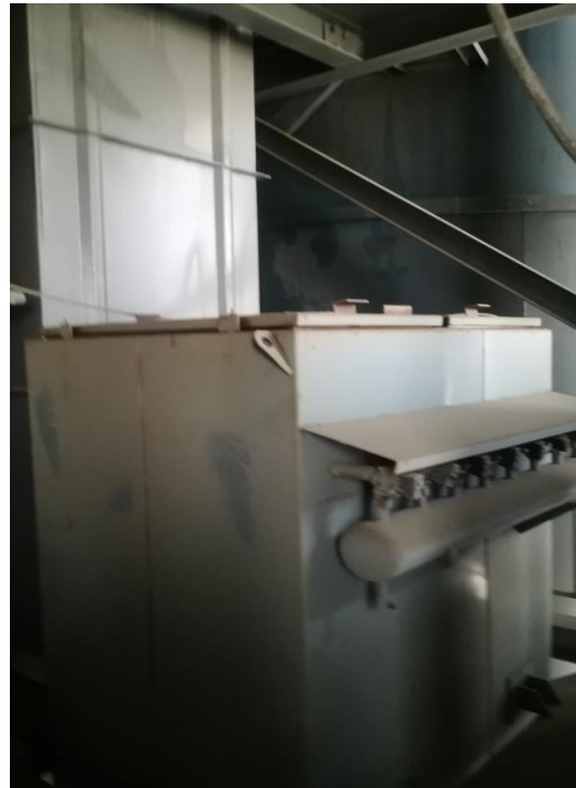
图 16 搅拌、缓冲仓粉尘袋式除尘器 TA011
