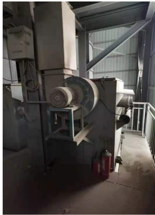
图 18 散装口袋式除尘器 TA012
