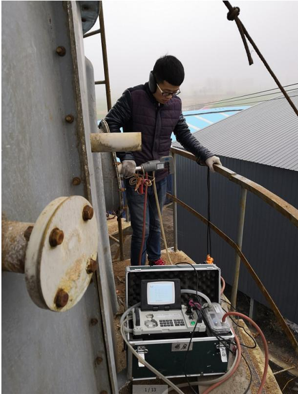
图 1 脱硫塔废气采样
